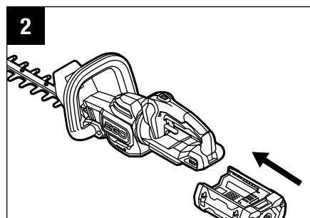
**NOTA:** Asegúrese de que el pestillo de la orilladora de arbustos se acople a presión en la posición correcta y que el paquete de batería esté fijo en la herramienta antes de comenzar su utilización.
